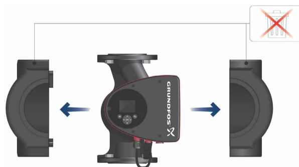
Rys. 3 Montaż okładzin termoizolacyjnych na pompie
