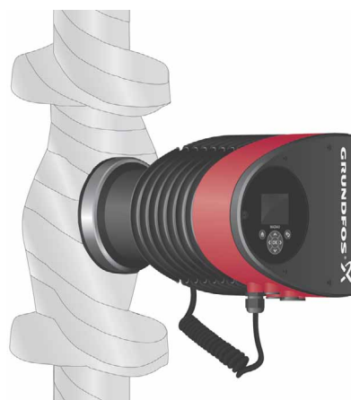
Rys. 4 Izolacja korpusu pompy i rurociągu
