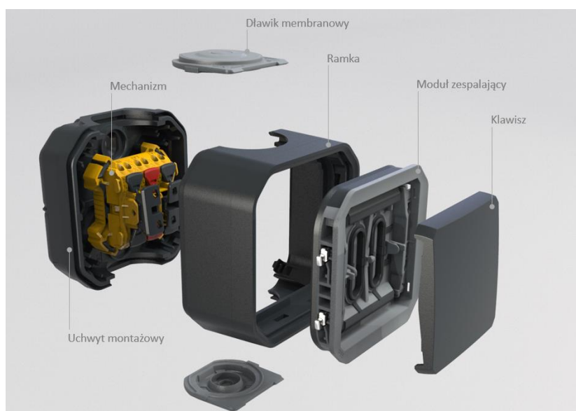
Konstrukcja łącznika natynkowego
