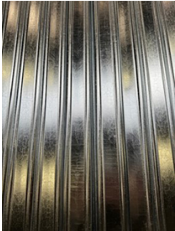
Powłoka tuż po cynkowaniu
