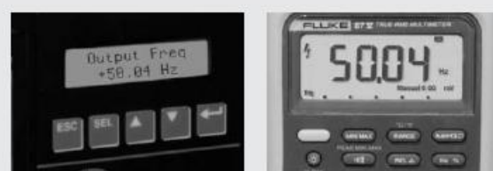
Rysunek 4. Częstotliwość wyjściowa (prędkość silnika) zmierzona z wykorzystaniem filtra dolnoprzepustowego.
