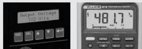
Rysunek 1. Odczyt napięcia wyjściowego bez wykorzystania filtra dolnoprzepustowego.
