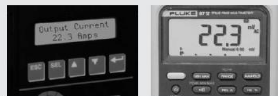
Rysunek 6. Odczyt prądu wyjściowego bez wykorzystania filtra dolnoprzepustowego.
