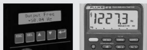
Rysunek 3. Częstotliwość wyjściowa (prędkość silnika) bez filtra dolnoprzepustowego.
