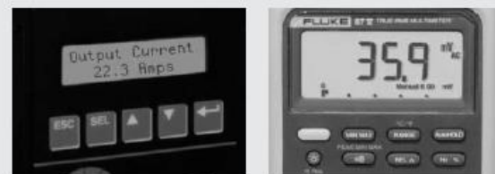
Rysunek 5. Odczyt prądu wyjściowego bez wykorzystania filtra dolnoprzepustowego.
