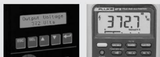
Rysunek 2. Odczyt napięcia wyjściowego z włączonym filtrem dolnoprzepustowym.
